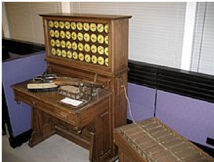
Рисунок 2 - Копия счетной машины Холлерита с сортировочным ящиком. Ок. 1890
